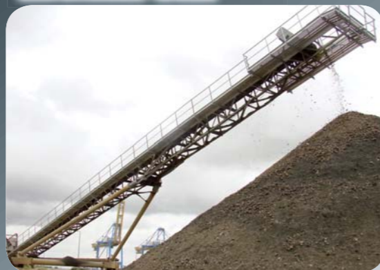
Convoyeur sauteur orientable Lg.45ml Grave de l'Estuaire - Le Havre
